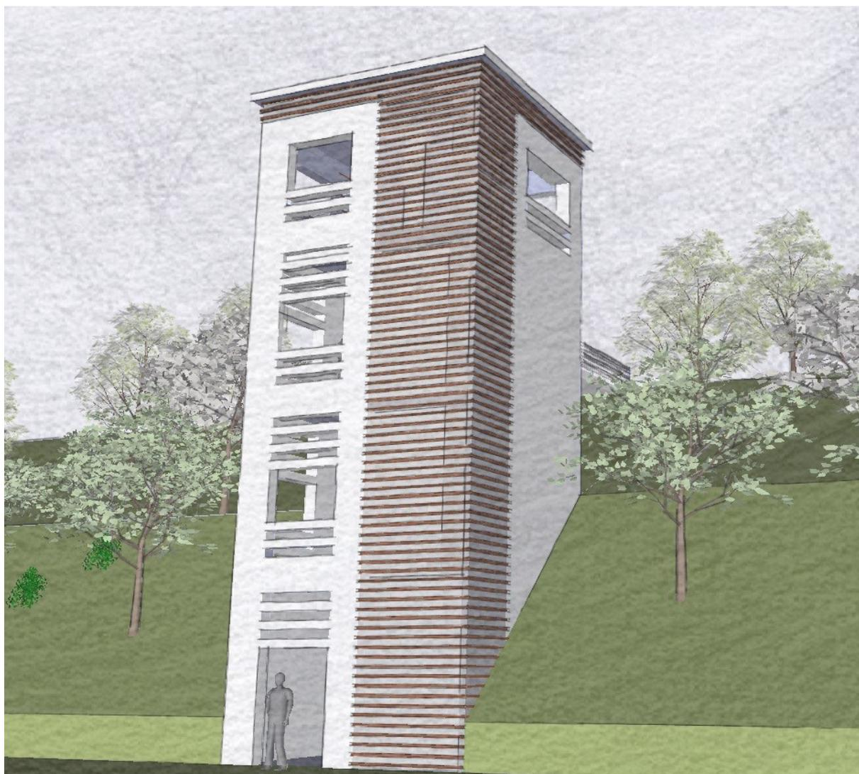
6. Finitura esterna con rivestimento in intonaco per esterni opportunamente tinteggiato e parte con frangisole in laterizio montato a secco su intelaiatura metallica in lega di alluminio
