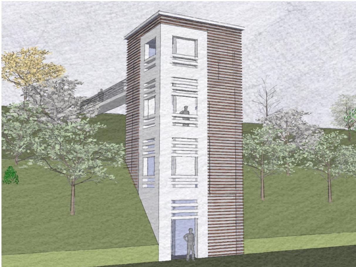
L'ascensore presenterà solamente n°3 fermate, la prima a quota +163.75 slm ovvero quella del parcheggio, la seconda intermedia di sicurezza a quota +171.75 slm, la terza a quota +175.75 slm al parcheggio di Viale Pascoli; il piano di imposta della torre manterrà pressoché inalterate le quote esistenti dell'area nelle sue immediate aree circostanti. Per quanto concerne le caratteristiche geologiche dell'area oggetto di intervento si rimanda a quanto scaturito dalle
